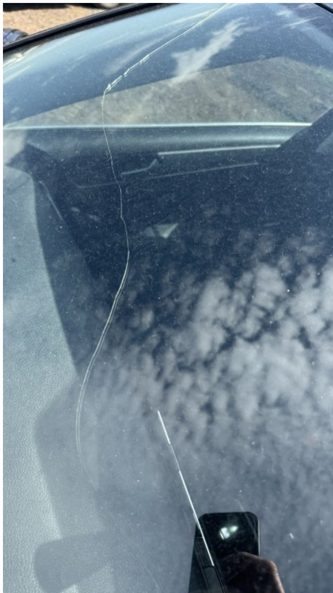
6. Лобовое стекло: Трещина
